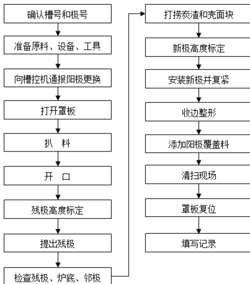
图 4 400kA 电解槽换极作业流程
